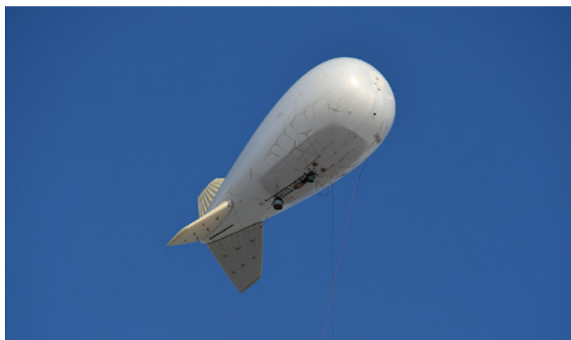
Mit Hightech-Überwachungskameras ausgestattetes Aerostat-Ballonsystem von FRONTEX
